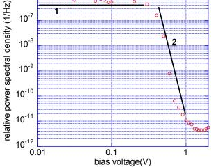
2,ここで大きく相対ノイズが減少するのは、外部からキャリアが注入され始めるからであると考 えられる。このとき、外部から注入されたキャリアはトラップ準位をトンネルで通りぬけるた め、電流に対してノイズ強度は I2の依存性はもたない。
