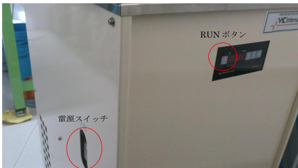
図1 冷却水循環器(加熱レーザー用)
