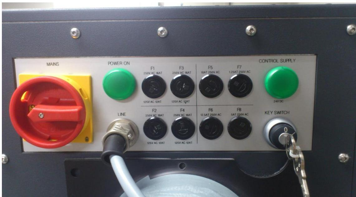
図 2 KrF レーザーの電源
